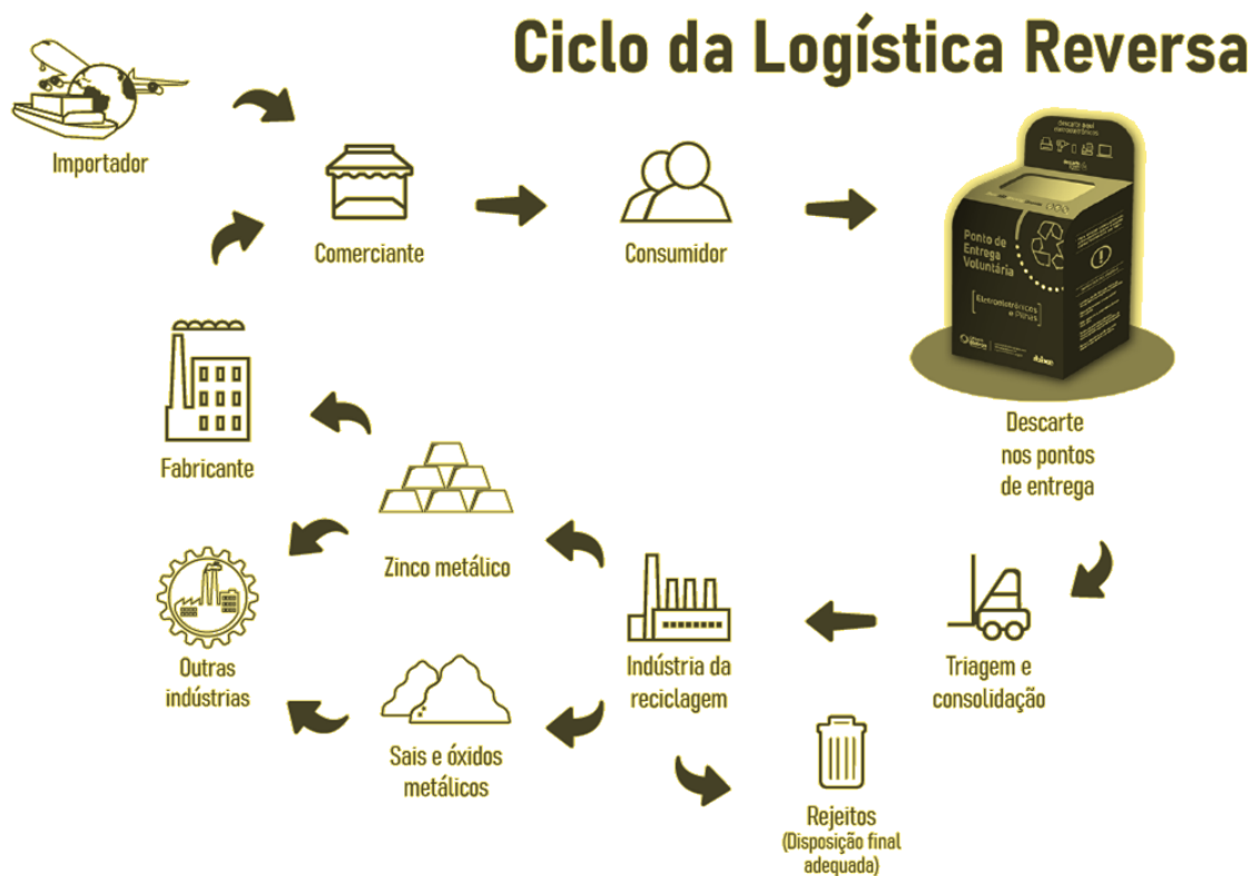
Figura 58: Ciclo da Logística Reversa de Pilhas e Baterias.
